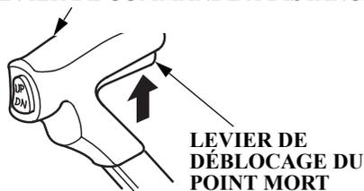
Le levier de déblocage de neutre prévu sur le levier de télécommande sert à empêcher le fonctionnement accidentel du levier de commande à distance.
