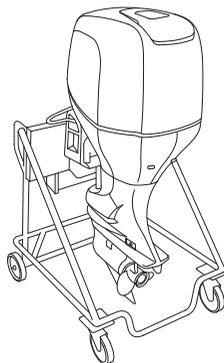
Transporter et remiser le moteur hors-bord verticalement comme il est illustré ci-dessus. Monter la chaise de fixation sur le support et fixer le moteur avec les boulons et écrous. Stocker le moteur dans un endroit bien aéré à l'abri du soleil et de l'humidité.
