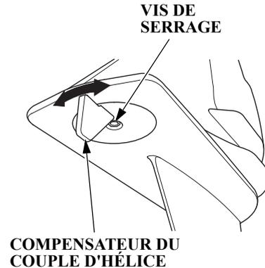
Si la barre est tirée d'un côté alors que le bateau avance à pleine vitesse, régler le compensateur du couple de l'hélice pour que le bateau conserve son cap.
